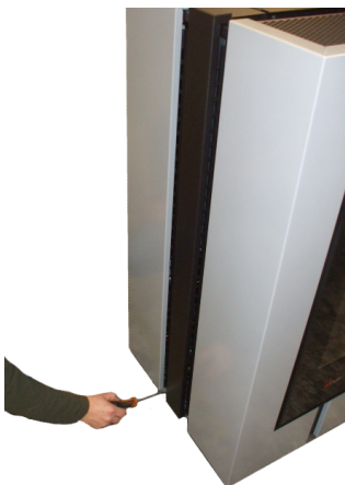
Fig. 67 - Retrait vis inférieures
