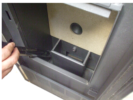
Fig. 61 - Nettoyage l'espace du brasero
