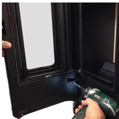
Fig. 74 - Desserrer la vis
