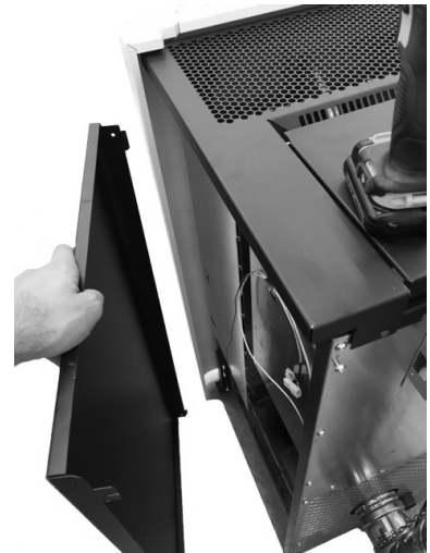
Fig. 28 - Verwijdering zijpanelen
