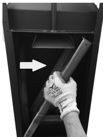
Fig. 42 - Verwijdering rookafvoer links
