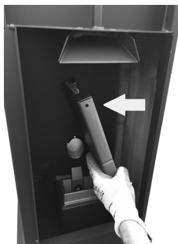
Fig. 44 - Verwijdering rookafvoer rechts
