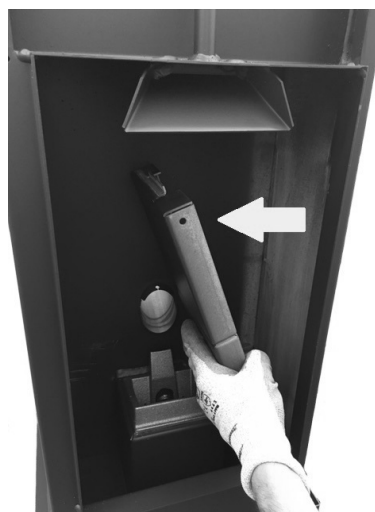
Fig. 44 - Rimozione girofumi destro
