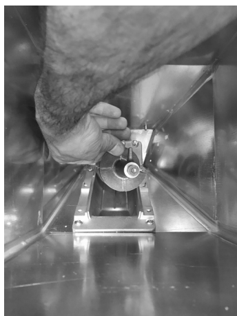
Fig. 39 - Rimozione spirale
