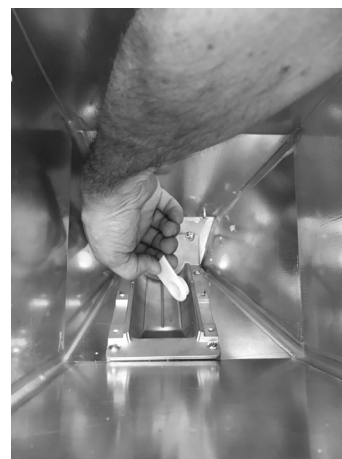
Fig. 40 - Rimozione cuscinetto
