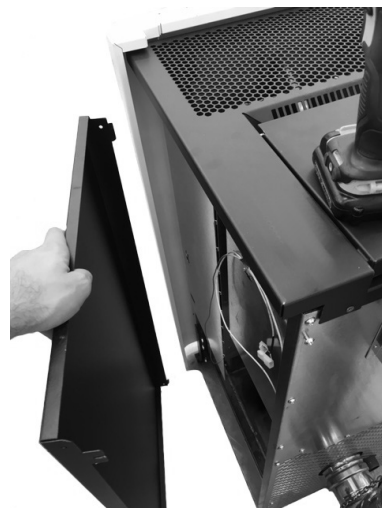
Fig. 28 - Rimozione fianchi
