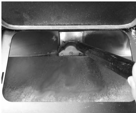
Fig. 22 - Rengøring af magasin og snegl
