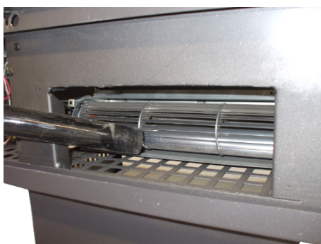
Fig. 40 - Pulizia ventilatore ambiente
