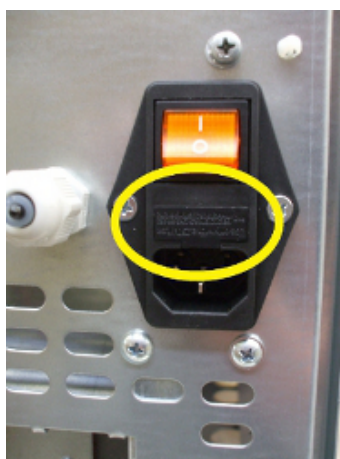
Fig. 45 - Sportellino con i fusibili da rimuovere
