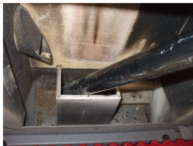
Fig. 30 - Pulizia vano braciere
