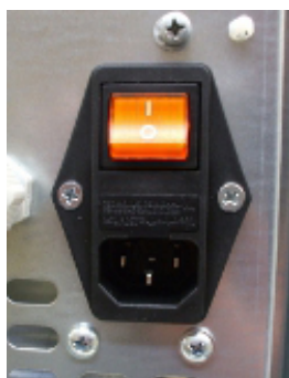
Fig. 21 - Presa elettrica con interruttore generale
