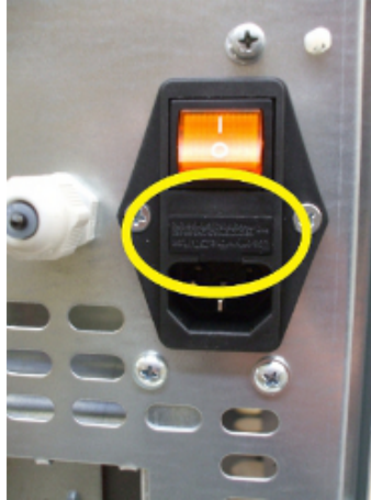
Fig. 45 - Drzwiczki z bezpiecznikami do wyjęcia
