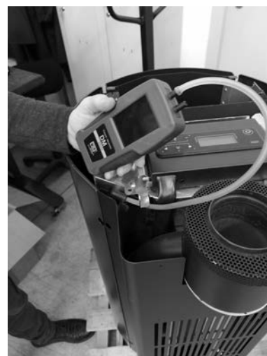
Fig. 62 - Połączenie presostatu cyfrowego
