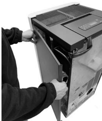
Fig. 31 - Odczepić boczne ścianki
