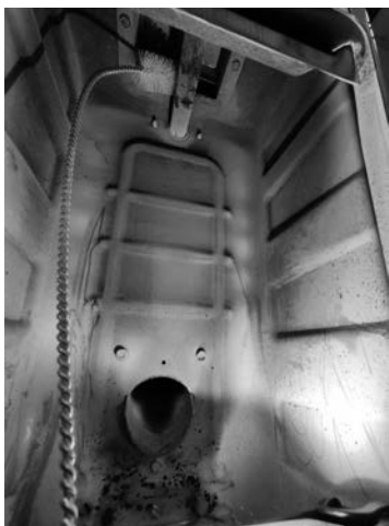
Fig. 71 - Wyczyścić szczotką do rur
