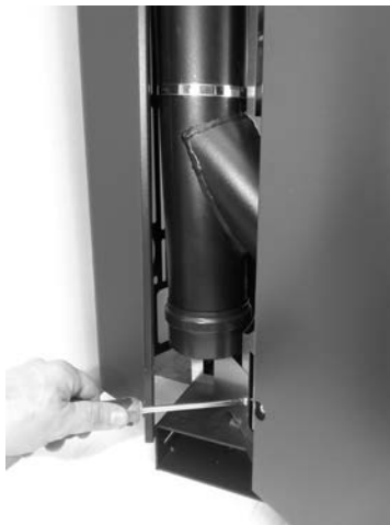
Fig. 65 - Wykręcić blokadę korka.
