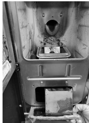
Fig. 68 - Usunąć zamknięcie rewizyjne.
