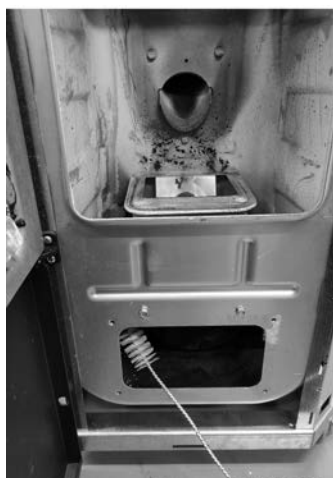
Fig. 69 - Wyczyścić szczotką do rur
