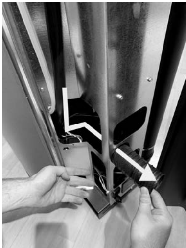
Fig. 55 - Przeprowadzanie węża 1
