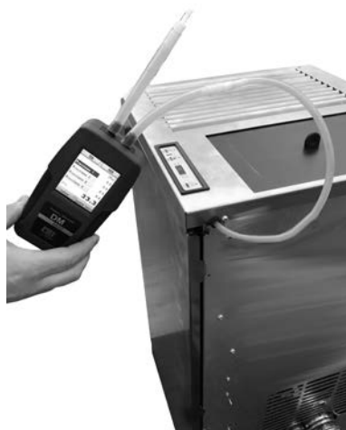
Fig. 61 - Połączenie presostatu cyfrowego
