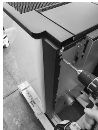
Fig. 38 - Przymocować kompletną boczną ściankę
