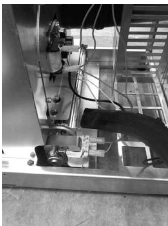
Fig. 73 - Czyszczenie wentylatora
