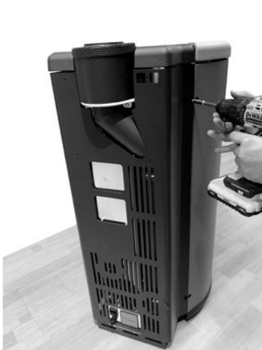
Fig. 52 - Carter verwijderen
