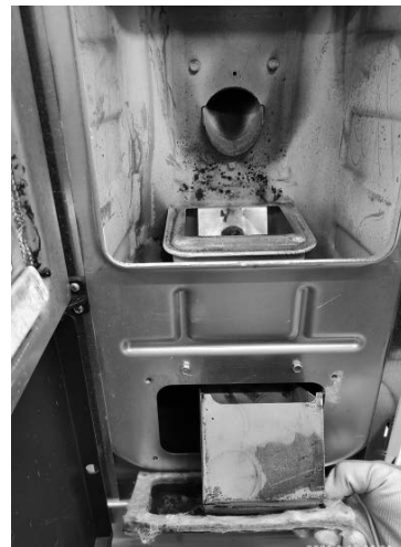
Fig. 67 - Verwijder de inspectiedop
