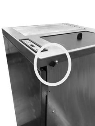
Fig. 60 - Carter verwijderen
