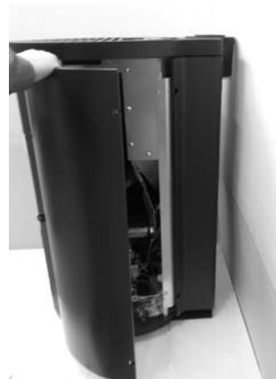
Fig. 46 - De zijpanelen loshaken
