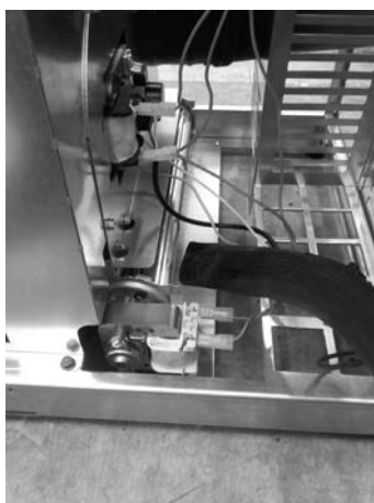
Fig. 72 - Reiniging omgevingsventilator
