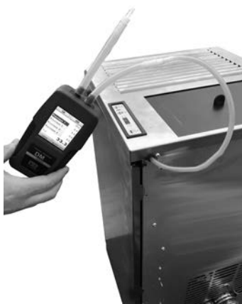
Fig. 61 - Aansluiting digitale drukregelaar
