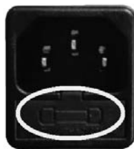
Fig. 73 - Deurtje met te verwijderen zekeringen
