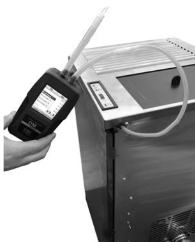
Fig. 61 - Tilslutning af digital trykmåler
