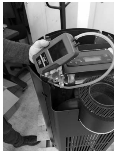
Fig. 62 - Tilslutning af digital trykmåler
