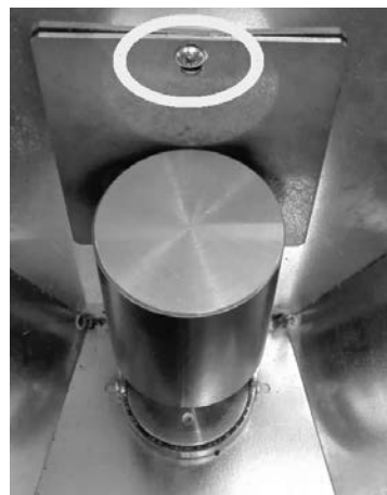
Fig. 76 - Fjernelse af skruer
