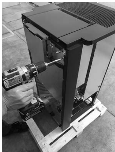
Fig. 36 - Fjern den sorte profil
