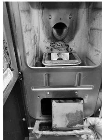
Fig. 68 - Fjern inspektionsdæksel
