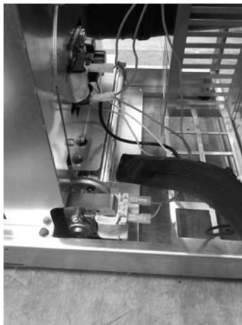
Fig. 73 - Rengøring af rumblæser
