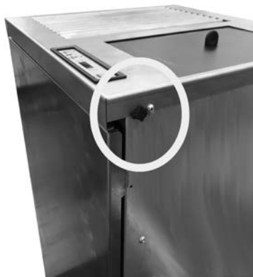
Fig. 60 - Borttagning af luger
