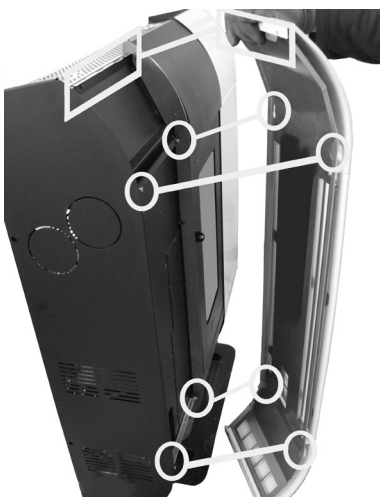
Fig. 31 - Einfügen der Platten
