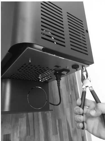
Fig. 46 - Abnehmen der Inspektionsabdeckung
