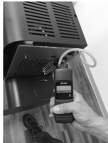
Fig. 47 - Anschluss des Digitaldruckwächters
