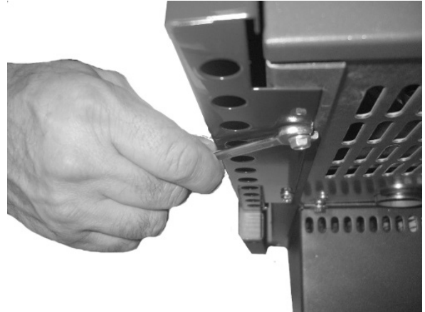
Fig. 30 - Befestigung der Platten
