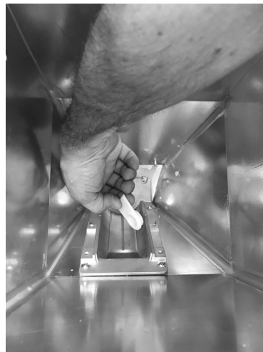
Fig. 52 - Lager entfernen
