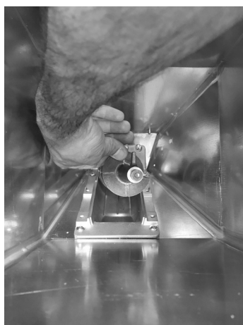
Fig. 80 - Odstranjevanje spirale
