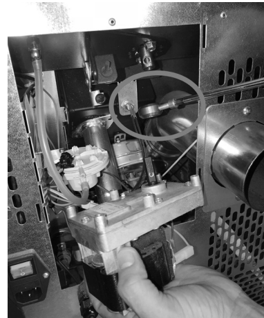
Fig. 79 - Odstranjevanje motoreduktorja
