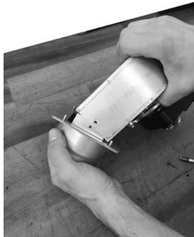
Fig. 32 - Den Flansch + Fitting am Ventilator fixieren.
