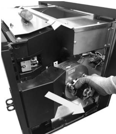
Fig. 60 - Den Ventilator entfernen
