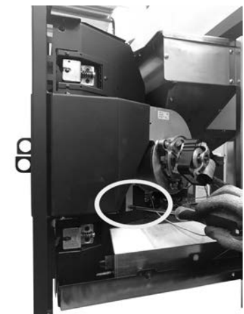
Fig. 59 - Die Schraube 2 entfernen.
