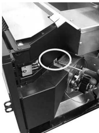
Fig. 58 - Die Schraube 1 entfernen.
