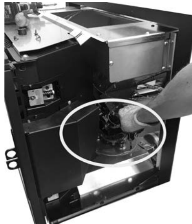
Fig. 61 - Die Schrauben entfernen.
