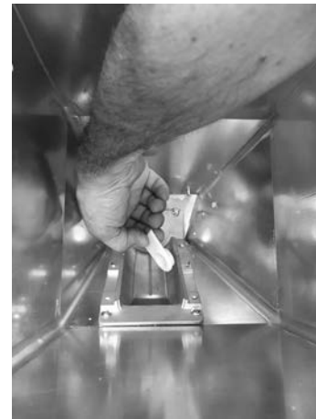
Fig. 56 - Lager entfernen
