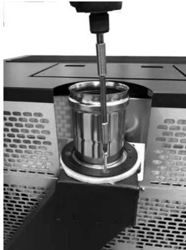
Fig. 42 - Lösen des Abzugs
