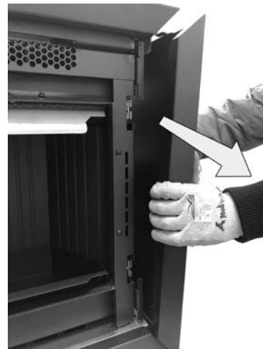
Fig. 25 - Die Seitenwand aushängen.
