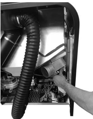
Fig. 37 - Das Gehäuse + Ventilator am Ofen fixieren.
