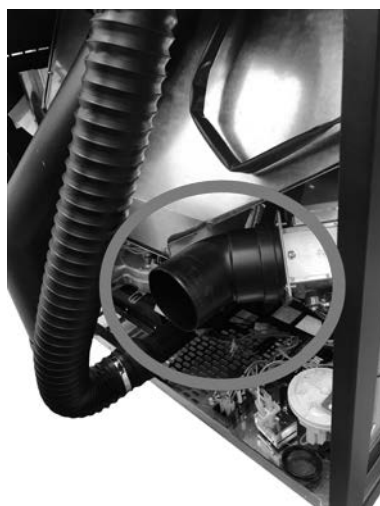
Fig. 38 - 45°-Fitting positionieren
