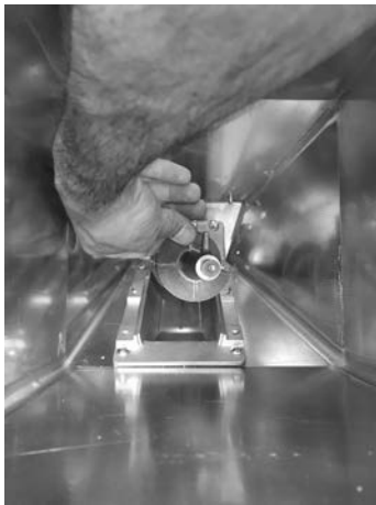
Fig. 55 - Spirale entfernen
