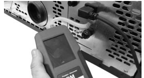
Fig. 51 - Anschluss des Digitaldruckwächters Modo At und Quasimodo³ Up
