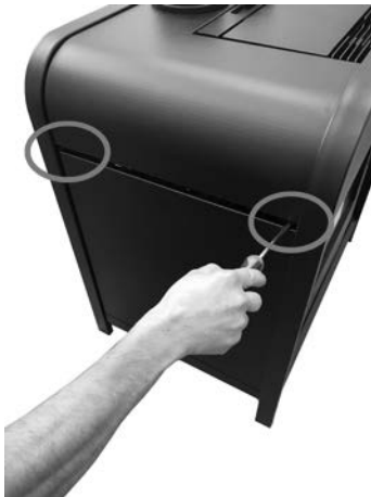
Fig. 22 - Die Schrauben entfernen.
