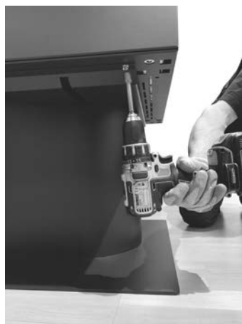
Fig. 18 - Befestigung des Sockels
