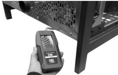
Fig. 50 - Anschluss des Digitaldruckwächters Frame³
