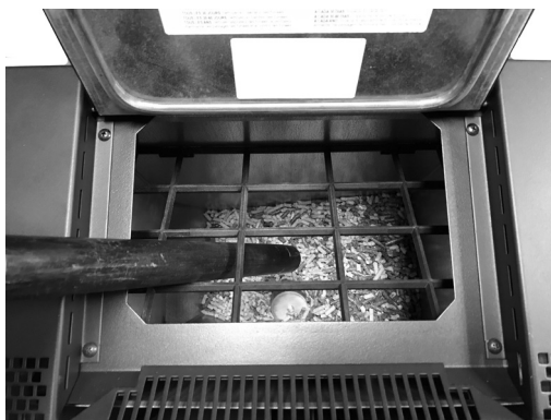
Fig. 32 - Reiniging van de voorraadbak en transportschroef
