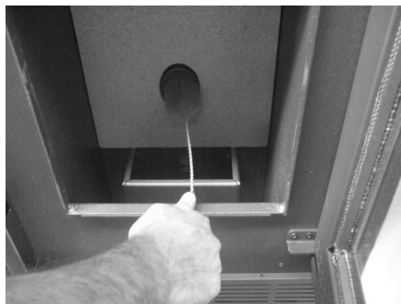
Fig. 31 - Reiniging met flessenwisser
