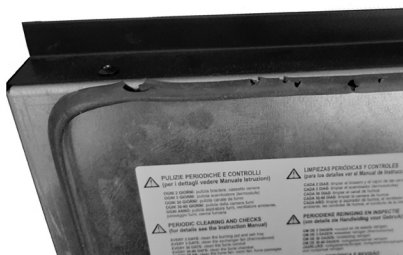
Fig. 23 - Junta deteriorada
