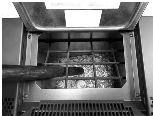
Fig. 32 - Limpeza do reservatório e da rosca sem fim
