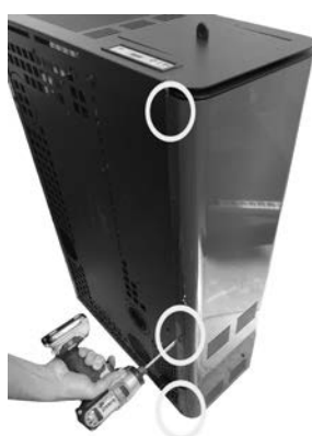
Fig. 48 - Usuwanie śrub 4
