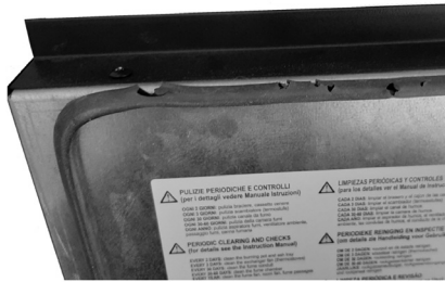
Fig. 21 - Verschlechterte Dichtung
