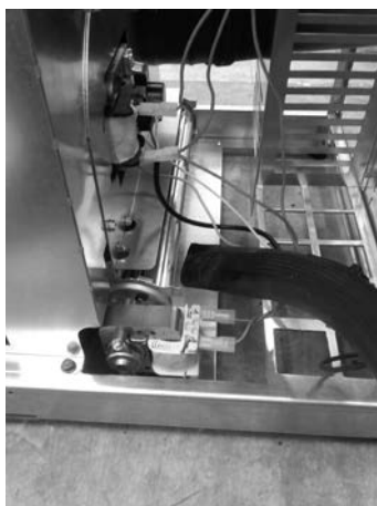
Fig. 36 - Nettoyage de le ventilateur ambiant
