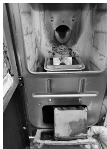
Fig. 31 - Retirer le bouchon d'inspection
