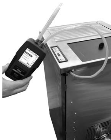
Fig. 28 - Connexion du pressostat numérique
