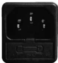
Fig. 25 - Prise électrique avec interrupteur général
