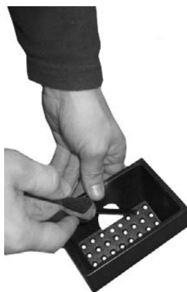
Fig. 28 - het schoonmaken van de vuurpot
