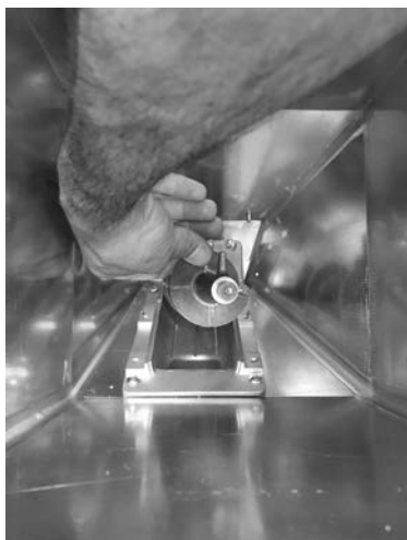
Fig. 91 - Remoção da espiral
