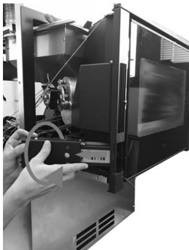
Fig. 81 - Rodar a caixa do ecrã
