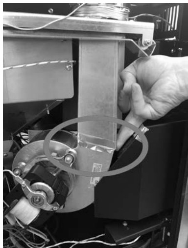
Fig. 46 - Vedar com fita adesiva de alumínio
