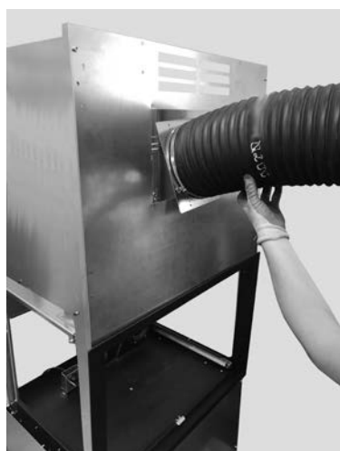
Fig. 64 - Posicionamento do tubo flexível
