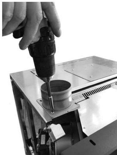
Fig. 47 - Fixar a junção
