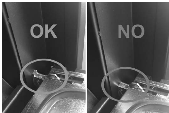
Fig. 69 - Encaixe correto da dobradiça
