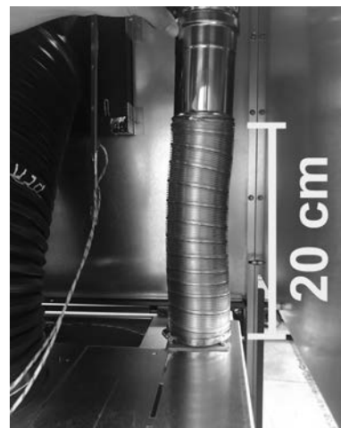
Fig. 48 - Conexão do tubo flexível (vista traseira da inserção)
