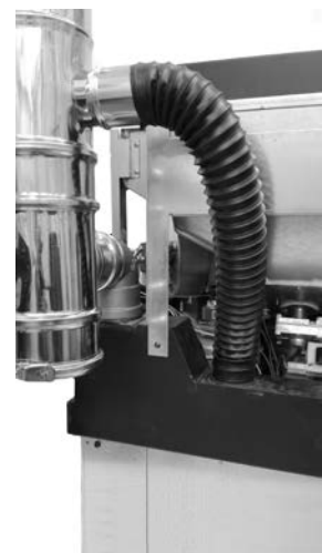
Fig. 77 - Conexão de tubo de ar de combustão
