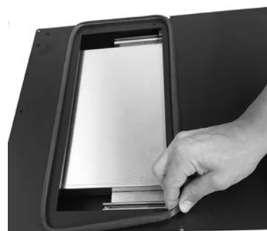
Fig. 52 - Posicionamento da guarnição
