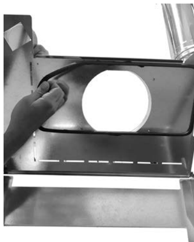
Fig. 51 - Remoção da guarnição
