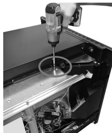
Fig. 55 - Fixação central da gaveta
