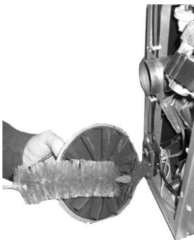
Fig. 98 - Limpeza do aspirador de fumos: fase1
