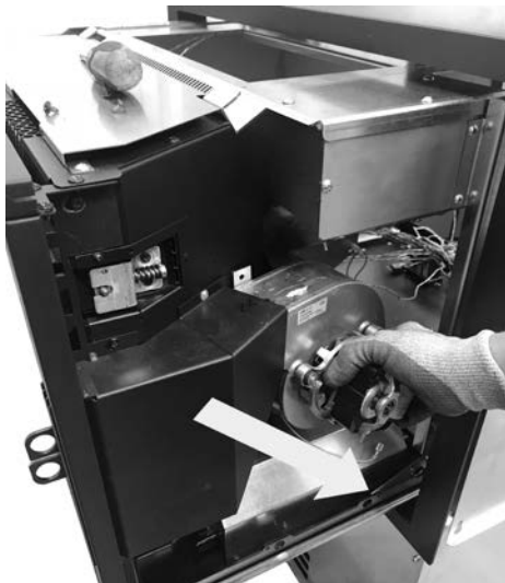
Fig. 96 - Remover o ventilador
