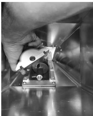
Fig. 89 - Remoção do casco
