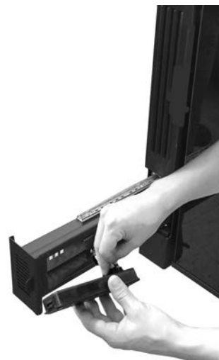
Fig. 83 - Conectar e reposicionar o ecrã
