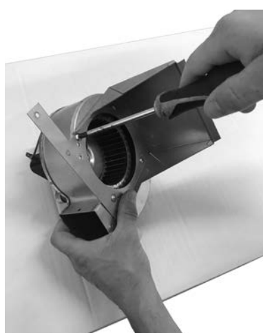
Fig. 41 - Remover os parafusos
