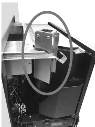
Fig. 43 - Posicione o desviador de ar
