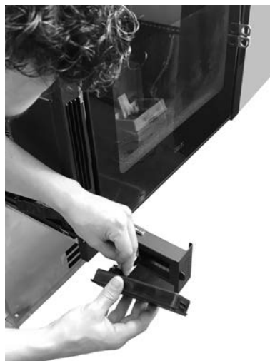
Fig. 79 - Remover o cabo flat
