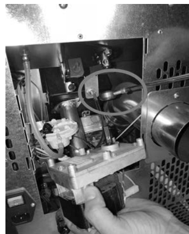
Fig. 90 - Remoção do motorreductor
