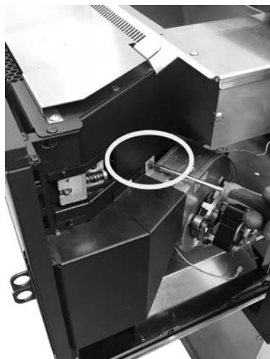
Fig. 94 - Remover o parafuso 1
