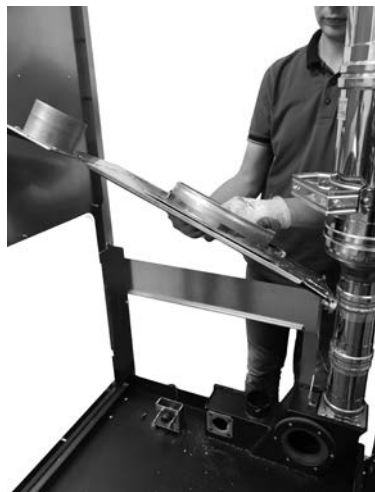
Fig. 57 - Remoção da tampa
