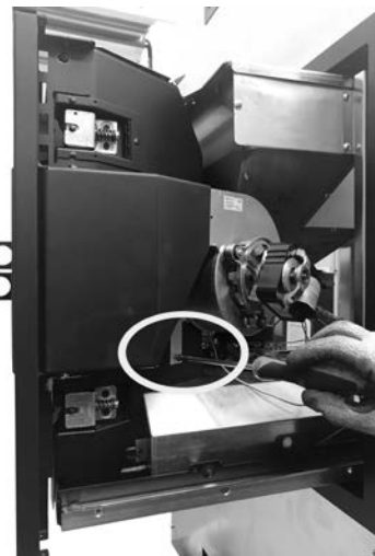
Fig. 95 - Remover o parafuso 2
