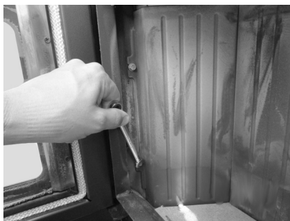
Fig. 37 - Extracción de los tornillos
