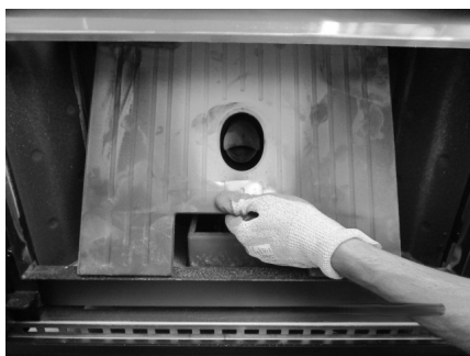
Fig. 39 - Extracción de la pared central de hierro fundido
