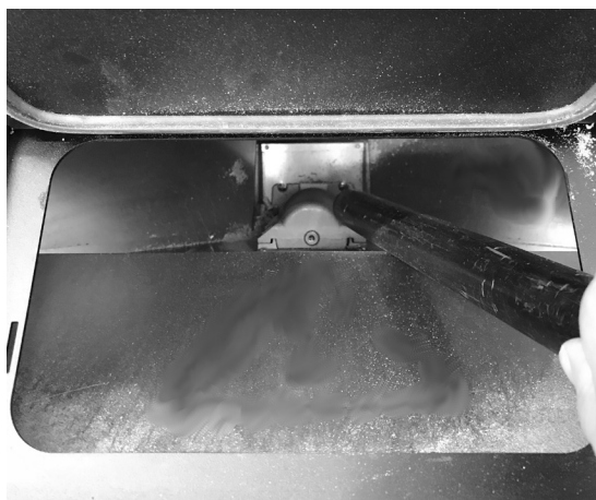
Fig. 35 - Limpieza depósito y coclea
