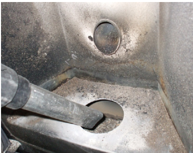
Fig. 33 - Reinigung Fach Brennschale
