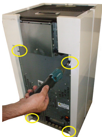
Fig. 18 - Die Schrauben entfernen
