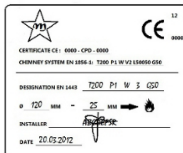
Fig. 3 - Beispiel für Typenschild
