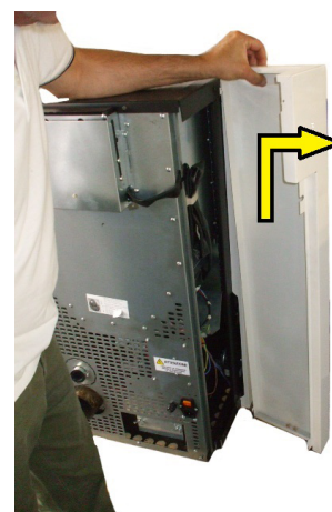
Fig. 20 - Die Seitenwand aushängen
