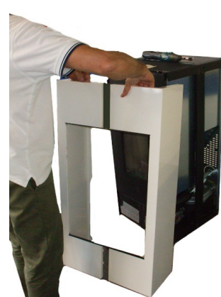
Fig. 23 - Herausziehen der Seitenwände: Phase 2
