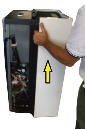
Fig. 21 - Die Seitenwand aushängen
