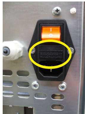
Fig. 48 - Abdeckklappe mit Sicherungen, die ausgewechselt werden müssen
