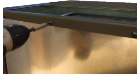
Fig. 14 - Die Schrauben auf der Rückseite entfernen
