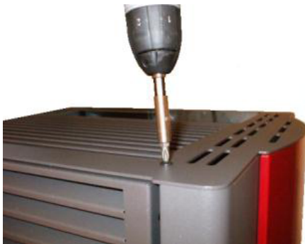
Fig. 13 - Die oberen Schrauben entfernen
