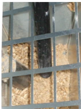
Fig. 36 - Reinigung Tank und Schnecke
