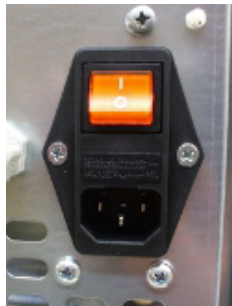
Fig. 24 - Elektrische Steckdose mit Hauptschalter
