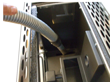
Fig. 22 - Nettoyer la chambre de combustion
