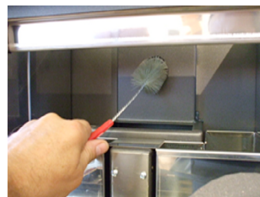
Fig. 25 - Nettoyage avec nettoie-pipes
