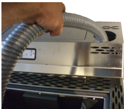
Fig. 30 - Nettoyage du collecteur des fumées
