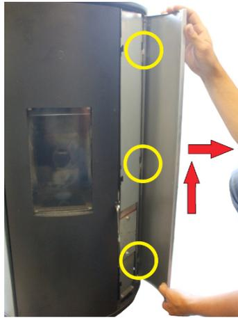
Fig. 66 - Sfera<sup>3</sup> / Sfera<sup>3</sup> Plus: unhook the side panels.
