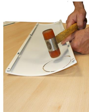
Fig. 30 - Open the hole (Sfera<sup>3</sup> Plus model)
