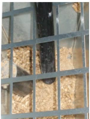
Fig. 31 - Limpieza depósito y coclea
