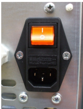
Fig. 19 - Tomada elétrica com interruptor geral
