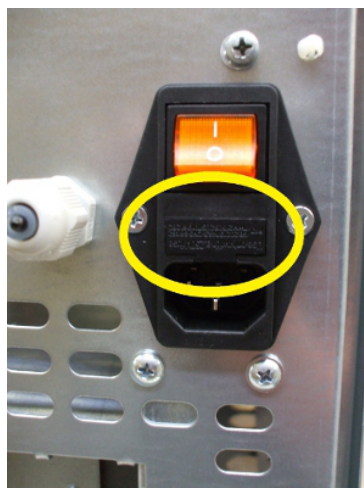
Fig. 42 - Porta com fusíveis a remover
