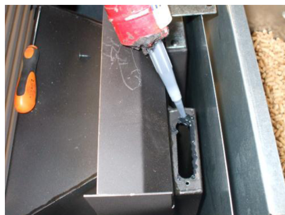
Fig. 41 - Colocación de la silicona
