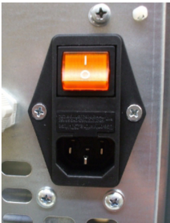
Fig. 19 - Toma de corriente con interruptor general
