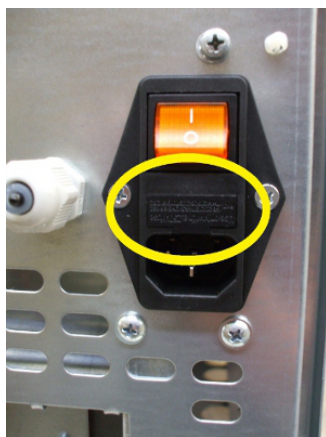
Fig. 42 - Ventanilla con los fusibles de remover
