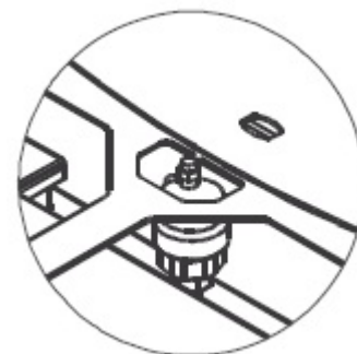
Fig. 23 - Valvola di sfiato sotto il top
