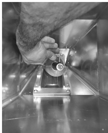
Fig. 39 - Remoção da espiral
