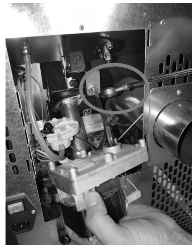
Fig. 38 - Remoção do motorreductor
