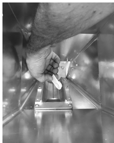
Fig. 40 - Remoção do rolamento
