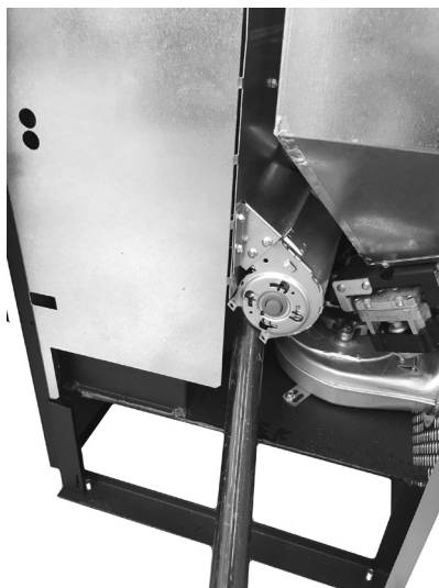
Fig. 45 - Limpeza do ventilador ambiente
