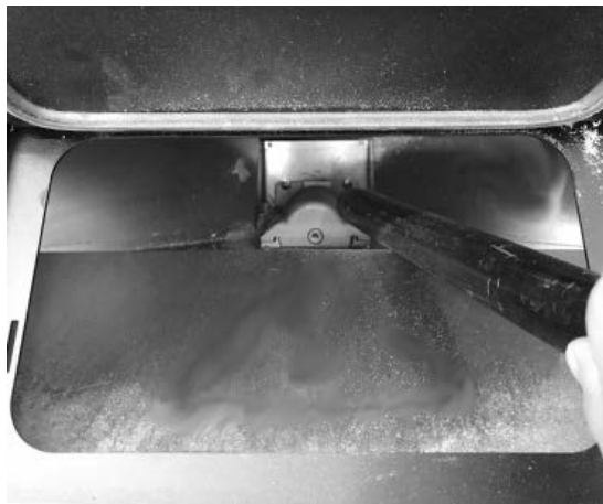
Fig. 22 - Reinigung Tank und Schnecke
