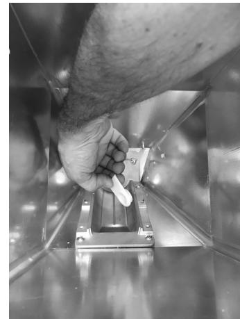
Fig. 82 - Remoção do rolamento
