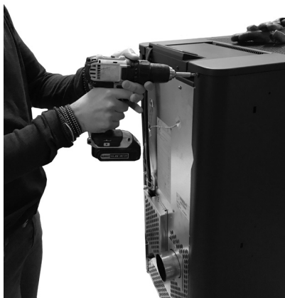
Fig. 48 - Remoção de parafusos
