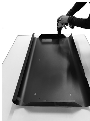
Fig. 51 - Aparafusar acabamento na lateral
