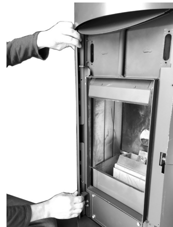
Fig. 66 - Remoção dos perfis dianteiros (dir. e esq.).
