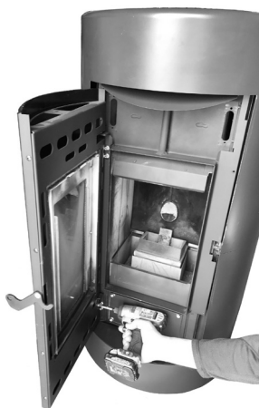
Fig. 64 - Remoção da porta
