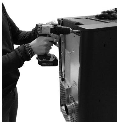
Fig. 48 - Usuwanie śrub
