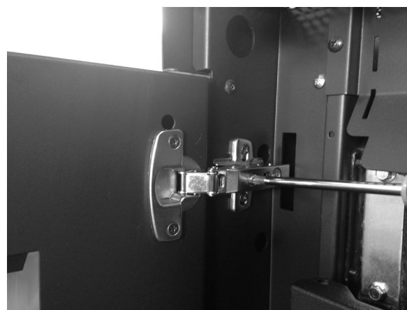
Fig. 44 - Regulacja drzwi
