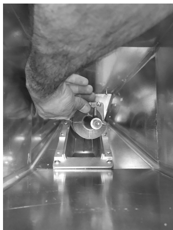
Fig. 81 - Usuwanie spirali
