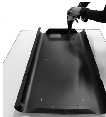
Fig. 51 - Dokręcanie płyty ozdobnej do ścianki bocznej
