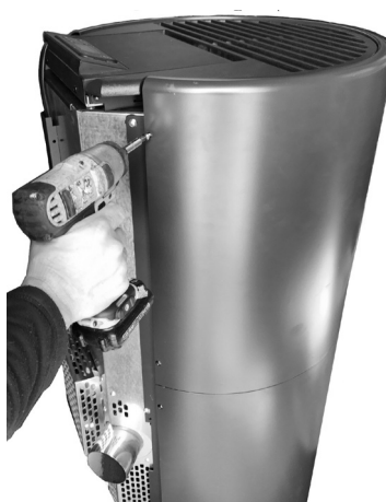
Fig. 67 - Usuwanie śrub tylnych
