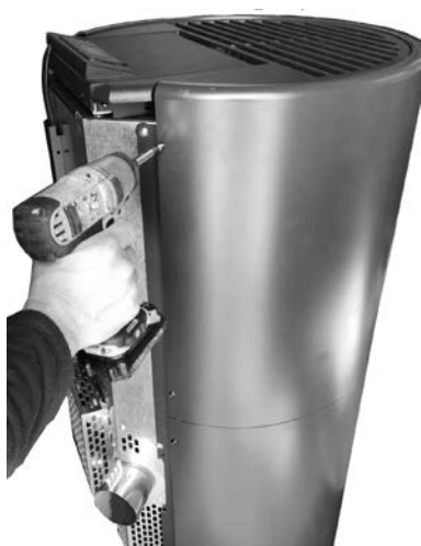
Fig. 67 - Verwijdering achterste schroeven
