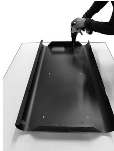
Fig. 51 - Schroef de afwerking aan het zijpaneel
