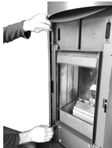
Fig. 66 - Verwijdering voorste profielen (rechts en links).
