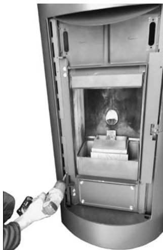
Fig. 65 - Verwijdering schroeven en profielen (rechts en links).
