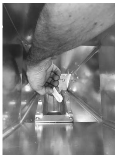
Fig. 82 - Verwijdering lager
