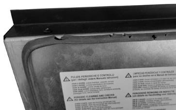
Fig. 21 - Verschlechterte Dichtung
