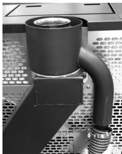
Fig. 48 - Połączenie 2 wlotów
