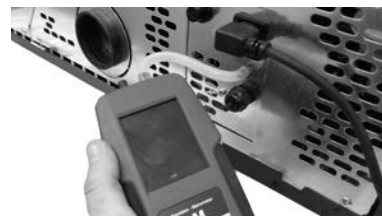
Fig. 51 - Podłączenie presostatu cyfrowego Modo At i Quasimodo³ Up
