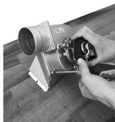
Fig. 36 - Przymocować śrubami.
