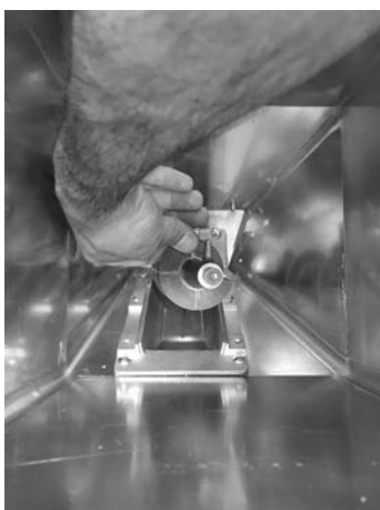
Fig. 55 - Usuwanie spirali
