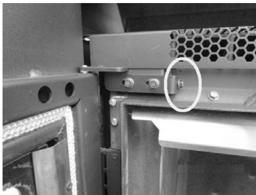
Fig. 26 - Regulacja drzwi
