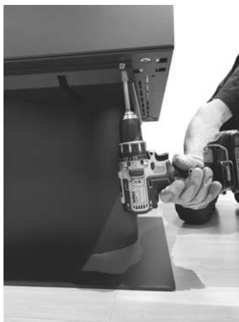
Fig. 18 - Mocowanie stojaka
