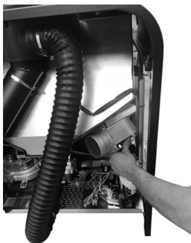
Fig. 37 - Przymocować obudowę + wentylator do pieca.
