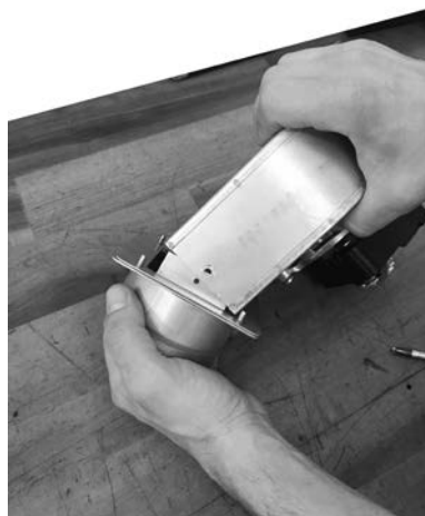
Fig. 32 - Przymocować kołnierz + złączkę do wentylatora.
