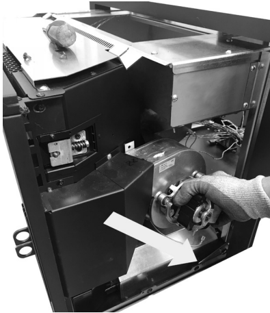
Fig. 60 - Verwijder de ventilator
