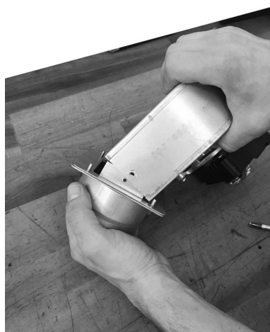
Fig. 32 - Bevestig de flens + de koppeling aan de ventilator
