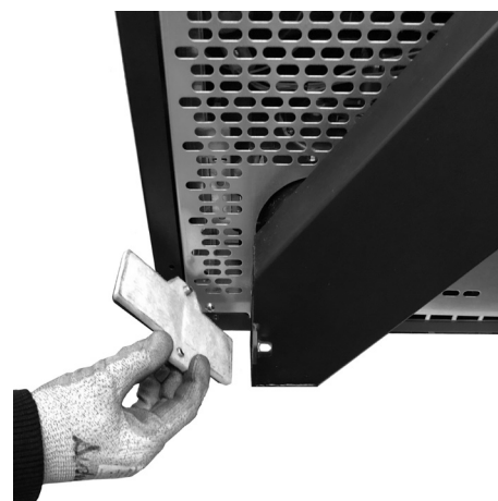
Fig. 65 - Reiniging rookleiding
