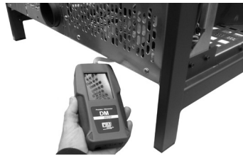
Fig. 50 - Aansluiting digitale drukregelaar Frame³
