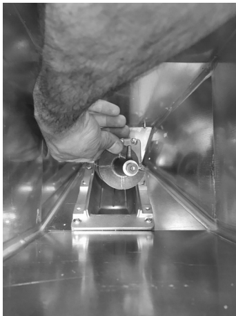
Fig. 55 - Verwijdering spiraal
