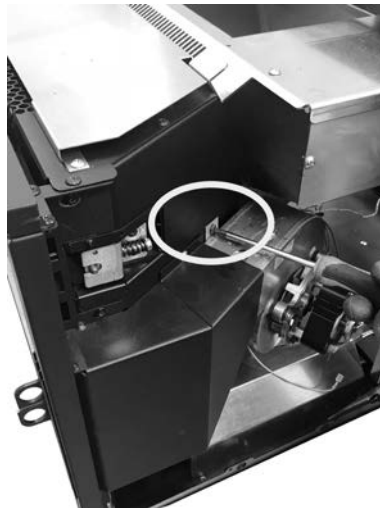
Fig. 67 - Retirer la vis 1
