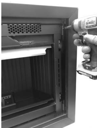
Fig. 33 - Retirer les vis
