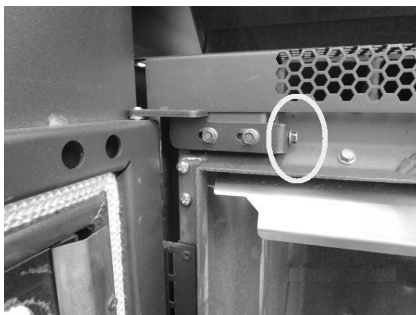
Fig. 35 - Réglage de la porte
