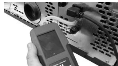
Fig. 60 - Connexion du pressostat numérique Modo At et Quasimodo³ Up
