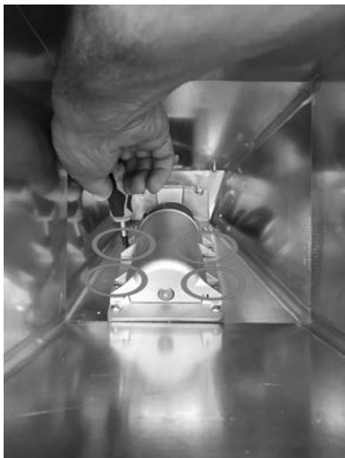
Fig. 61 - Retrait des vis
