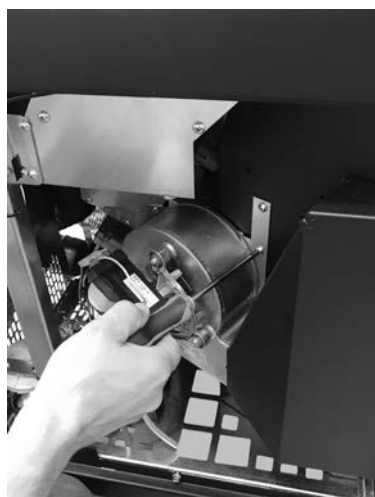
Fig. 38 - Retirer les vis
