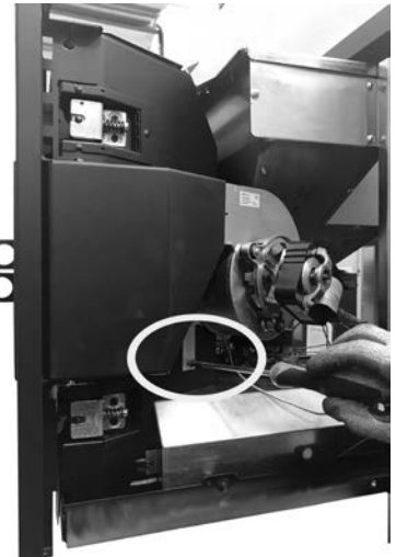
Fig. 68 - Retirer la vis 2
