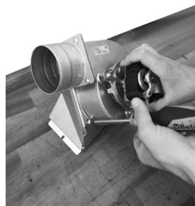
Fig. 45 - Fixer avec des vis
