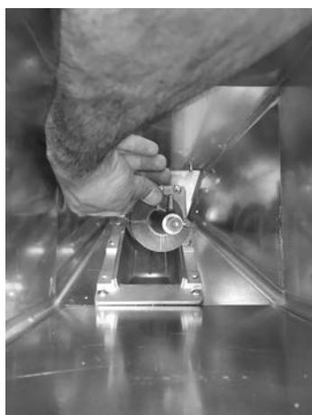
Fig. 64 - Retrait des spirales
