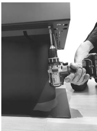
Fig. 27 - Fixation du socle
