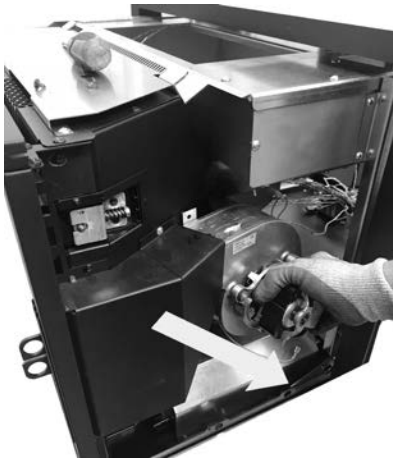
Fig. 69 - Retirer le ventilateur
