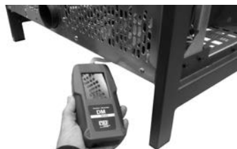
Fig. 59 - Connexion du pressostat numérique Frame³
