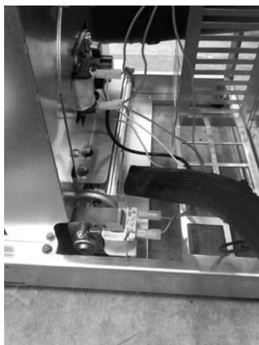
Fig. 35 - Rengøring af rumblæser
