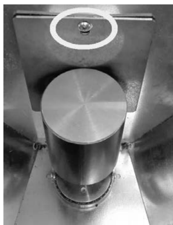
Fig. 38 - Fjernelse af skruer
