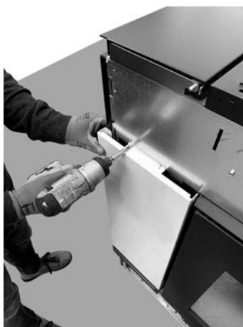
Fig. 35 - Fixar os painéis laterais
