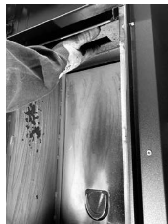
Fig. 97 - Remover o topo da fornalha 1
