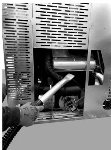
Fig. 108 - Limpeza do ventilador ambiente (Mithos³ Plus 12/14)
