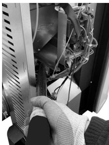
Fig. 107 - Limpeza do ventilador ambiente (Atena³ Plus 12/14 - Duke 12/14 At - Saba 12/14)
