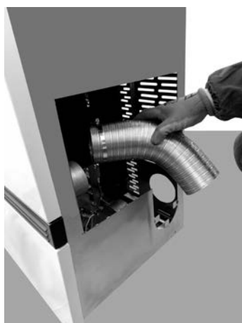
Fig. 76 - Remover o tubo flexível
