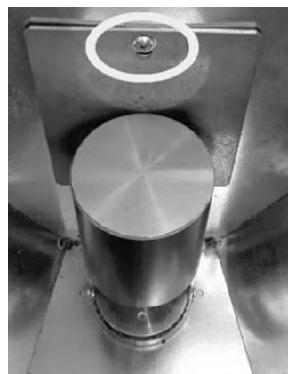
Fig. 111 - Remoção do parafuso
