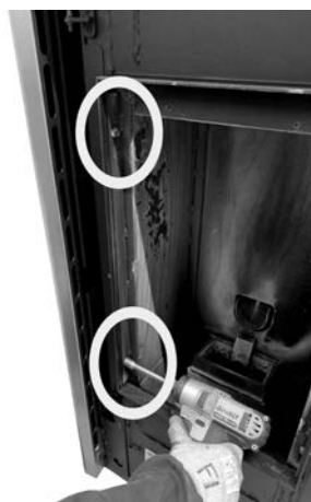
Fig. 96 - Remover os parafusos sextavados
