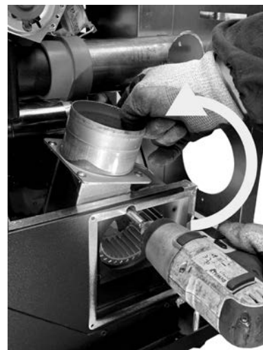
Fig. 62 - Remover o ventilador
