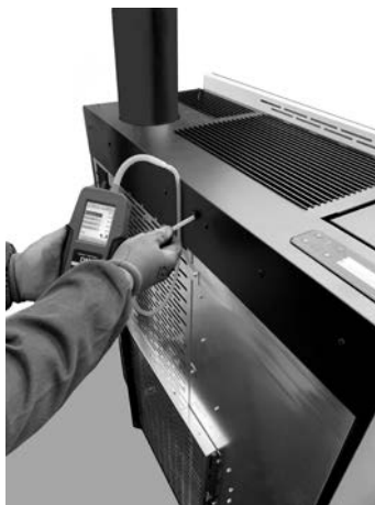
Fig. 89 - Ligação do pressóstato digital (Mithos³ Plus12/14)
