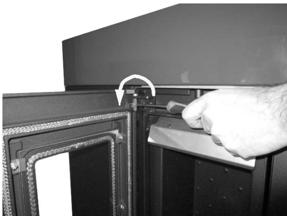
Fig. 18 - Remoção de parafusos
