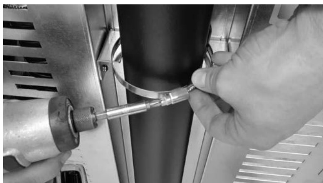
Fig. 56 - Bloquear com abraçadeira
