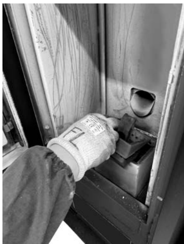
Fig. 27 - Wyjmowanie rusztu paleniskowego
