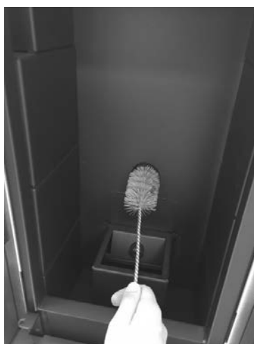
Fig. 30 - Czyszczenie szczotką do rur
