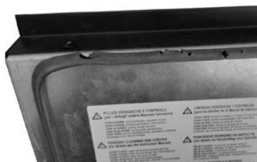
Fig. 23 - Zniszczona uszczelka
