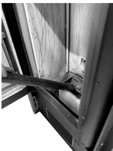
Fig. 29 - Czyszczenie miejsca na ruszt paleniskowy
