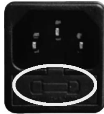
Fig. 114 - Ventanilla con los fusibles de remover
