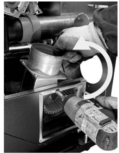
Fig. 67 - Gire el ventilador
