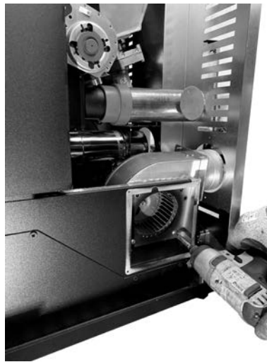
Fig. 66 - Extraiga los tornillos del ventilador
