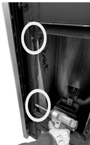
Fig. 101 - Extraiga los tornillos hexagonales
