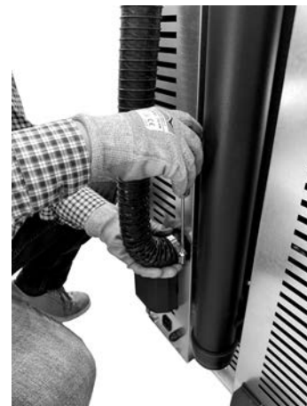
Fig. 60 - Acople el tubo de aire comburente
