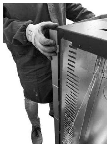
Fig. 31 - Retire las paredes laterales
