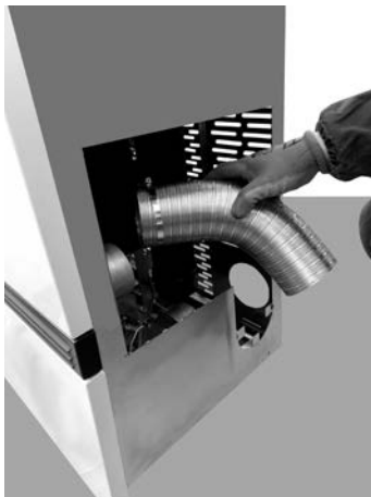
Fig. 81 - Den Schlauch entfernen
