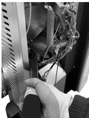
Fig. 112 - Limpieza ventilador ambiente (Atena³ Plus 12/14 - Duke 12/14 At - Saba 12/14)
