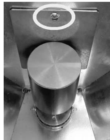
Fig. 116 - Retirada del tornillo
