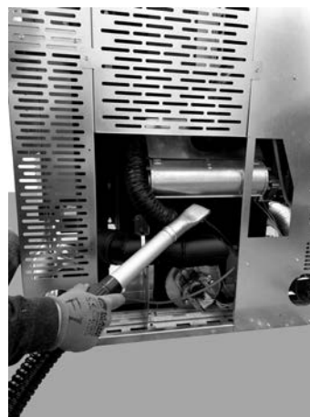
Fig. 113 - Limpieza ventilador ambiente (Mithos³ Plus 12/14)
