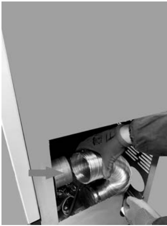
Fig. 83 - Den Schlauch abziehen
