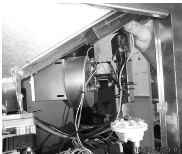
Fig. 94 - Fixation module WI-FI
