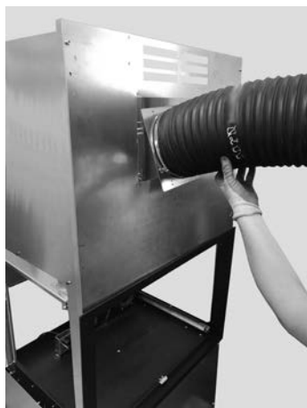
Fig. 71 - Positionnement du tuyau flexible
