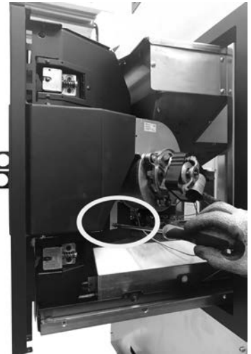
Fig. 102 - Retirer la vis 2
