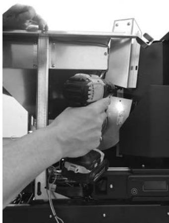
Fig. 51 - Fixer le ventilateur
