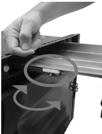
Fig. 63 - Réglage pour le centrage
