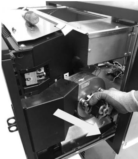
Fig. 103 - Retirer le ventilateur
