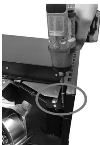
Fig. 61 - Fixation avant du tiroir
