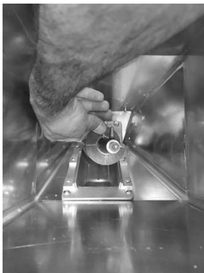
Fig. 98 - Retrait des spirales
