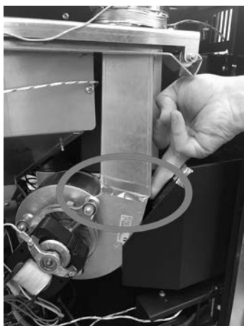
Fig. 53 - Sceller avec du ruban adhésif en aluminium
