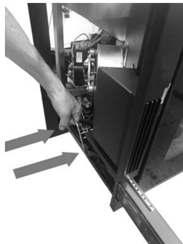
Fig. 30 - Retrait du corps machine
