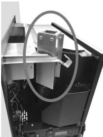
Fig. 50 - Positionner le déviateur de l'air
