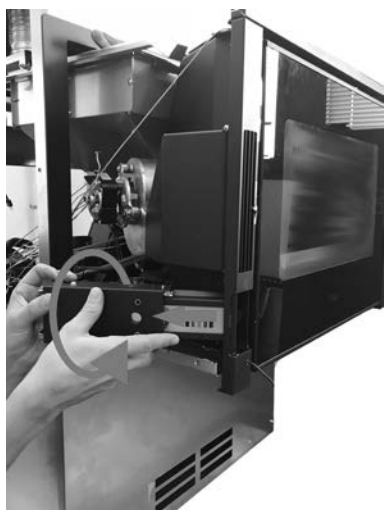
Fig. 88 - Tourner le boîtier porte-écran
