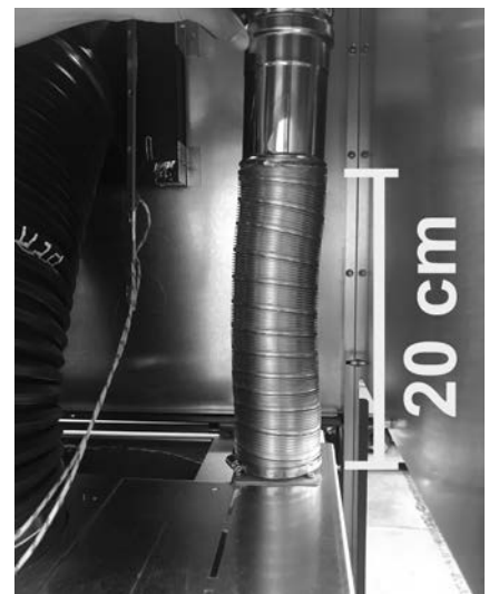
Fig. 48 - Anschluss Schlauch / Hinteransicht des Einsatzes)
