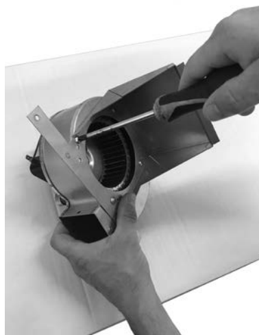
Fig. 41 - Schrauben entfernen
