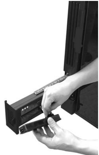
Fig. 83 - Das Display anschließen und neu positionieren
