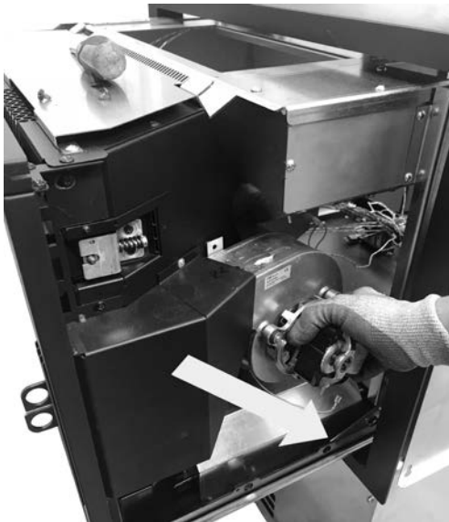
Fig. 96 - Den Ventilator entfernen
