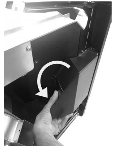
Fig. 39 - Feder biegen
