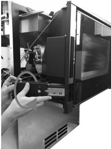
Fig. 81 - Den Displaykasten drehen
