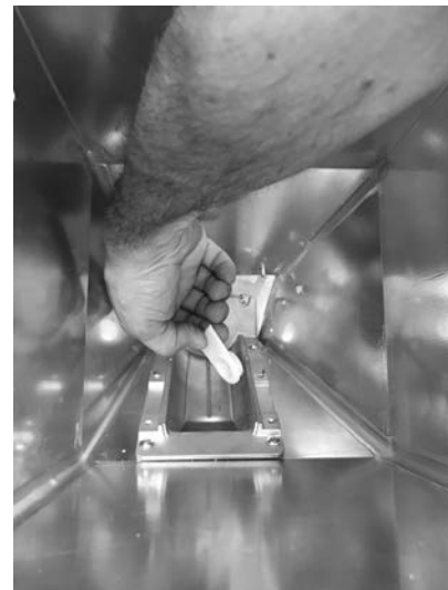
Fig. 92 - Lager entfernen
