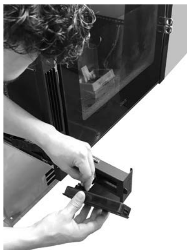
Fig. 79 - Das Flachkabel entfernen
