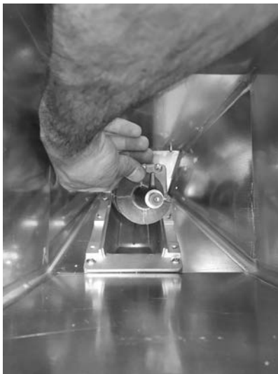
Fig. 91 - Spirale entfernen
