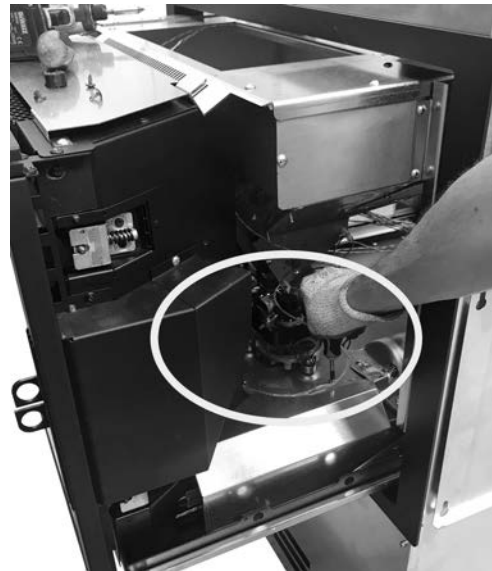
Fig. 97 - Die Schrauben entfernen
