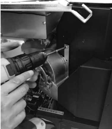
Fig. 37 - Gebläse entfernen
