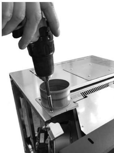
Fig. 47 - Den Anschluss befestigen
