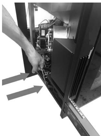
Fig. 23 - Maschinenkörper entfernen
