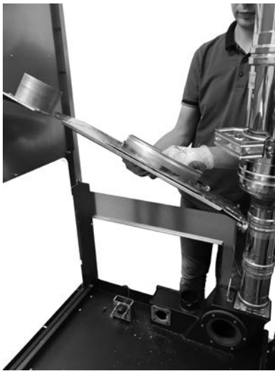
Fig. 57 - Entfernen der Abdeckung
