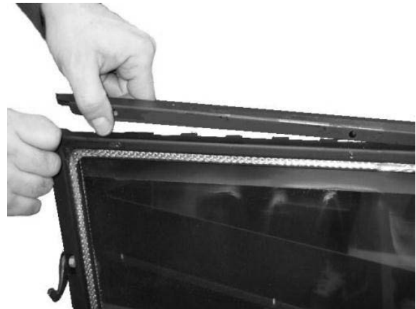
Fig. 101 - Entfernen der Türprofile
