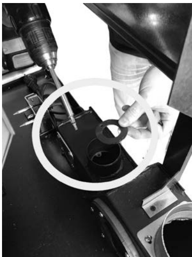
Fig. 75 - Den Ring entfernen.
