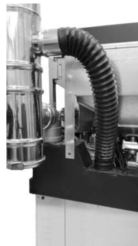
Fig. 77 - Anschluss der Verbrennungsluftleitung
