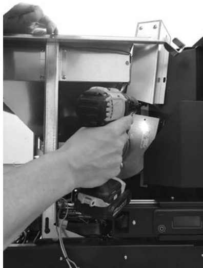
Fig. 44 - Gebläse befestigen
