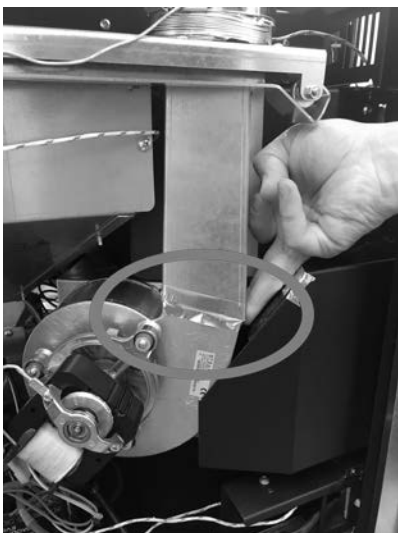
Fig. 46 - Mit Aluminiumklebeband versiegeln
