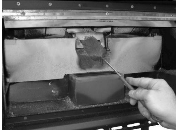
Fig. 34 - Reinigung mit Flaschenbürste
