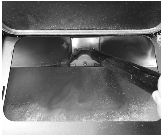
Fig. 35 - Reinigung Tank und Schnecke
