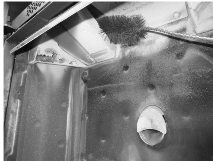
Fig. 40 - Reinigung mit Flaschenbürste
