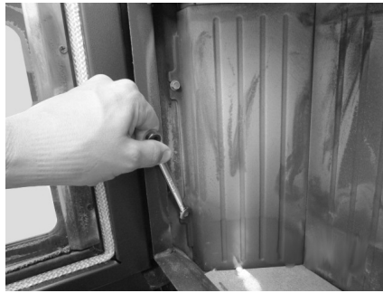
Fig. 37 - Lösen der Schrauben
