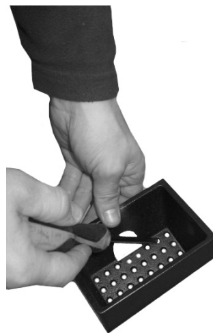
Fig. 32 - Reinigung Brennschale
