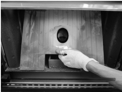
Fig. 39 - Entfernung der mittleren Wand aus Gusseisen
