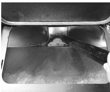
Fig. 24 - Nettoyage réservoir et vis sans fin
