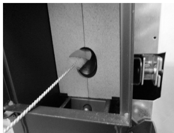
Fig. 23 - Nettoyage avec nettoie-pipes
