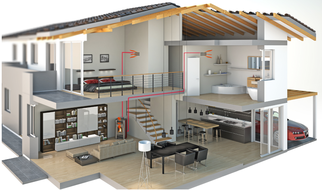
Fig. 31 - Beispiel einer Kanalisierung
