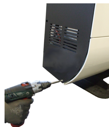
Fig. 22 - Untere Befestigung Platten
