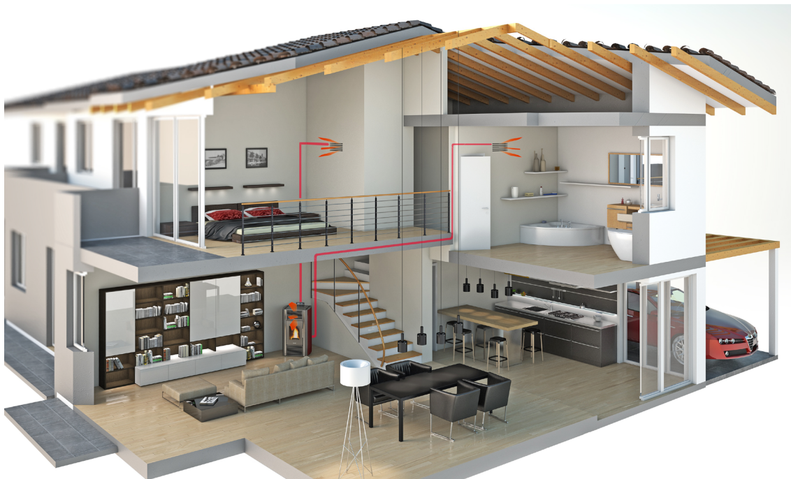
Fig. 35 - Beispiel einer Kanalisierung
