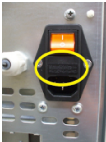
Fig. 62 - Abdeckklappe mit Sicherungen, die ausgewechselt werden müssen
