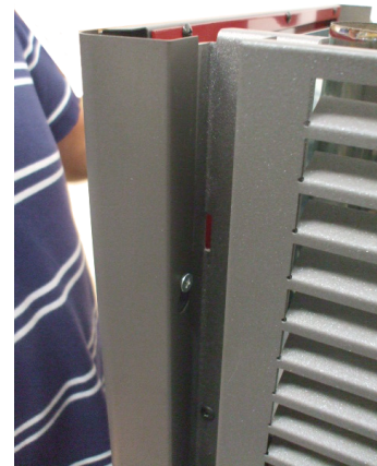
Fig. 22 - Einsetzen der Seitenwand
