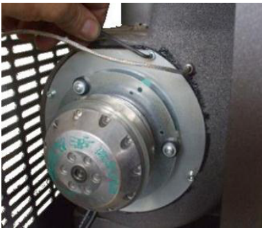
Fig. 50 - Reinigung Rauchgasansauggerät: Phase 1
