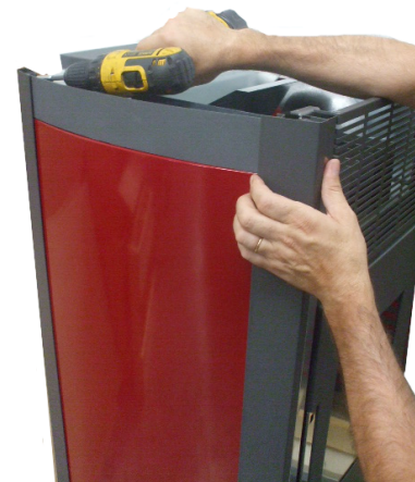
Fig. 18 - Wiederanbringen der oberen gebogenen Profile
