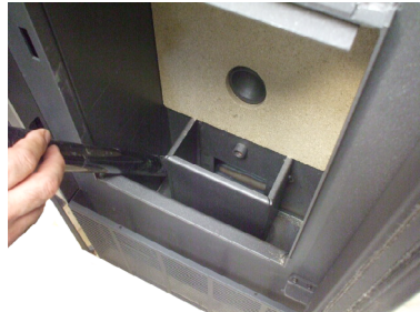
Fig. 44 - Reinigung Fach Aschenkasten
