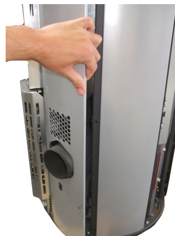
Fig. 18 - Montering af panel med huller
