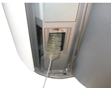
Fig. 52 - Rengøring med børste kanaler
