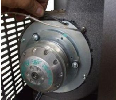
Fig. 43 - Rengøring af røgsuger: trin 1
