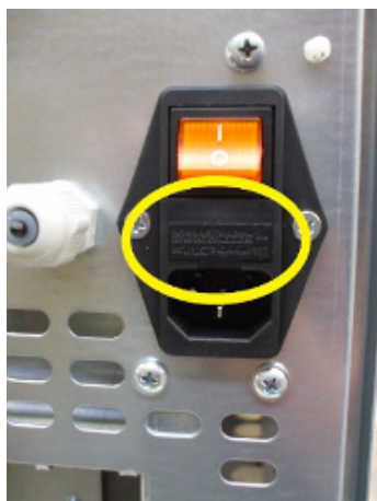
Fig. 63 - Dæksel med sikringerne, der skal fjernes
