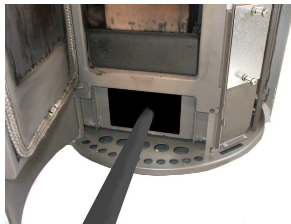
Fig. 41 - Rengøring af røgkammer
