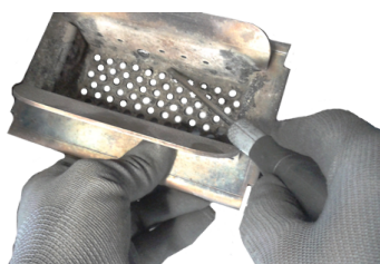
Fig. 26 - Καθαρισμός δοχείου καύσεως
