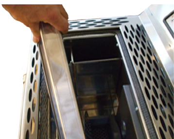
Fig. 21 - Verwijdering van de kookplaat
