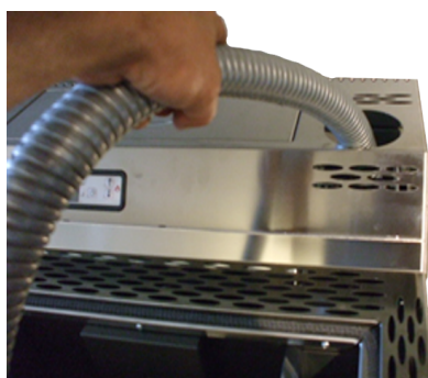
Fig. 31 - Fume conduit cleaning
