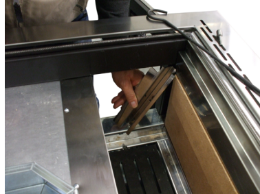
Fig. 19 - Verwijder het profiel
