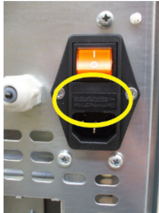
Fig. 106 - Abdeckklappe mit Sicherungen, die ausgewechselt werden müssen
