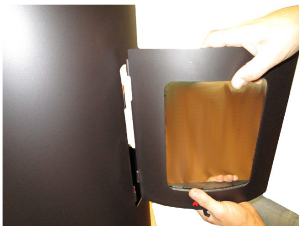
Fig. 27 - Ausbau der Tür
