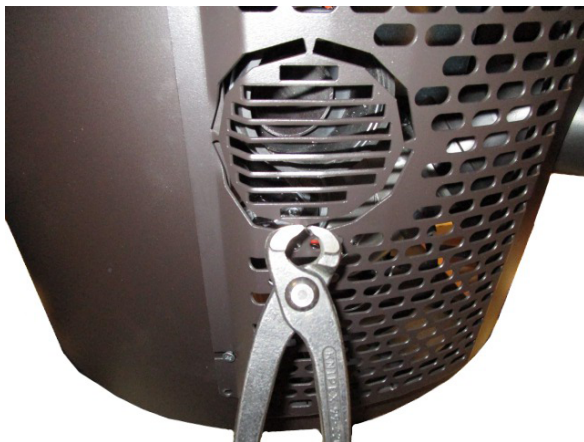
Fig. 12 - Entfernung des Deckels
