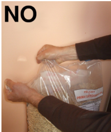
Fig. 81 - Fehlerhafte Öffnung des Pelletsacks
