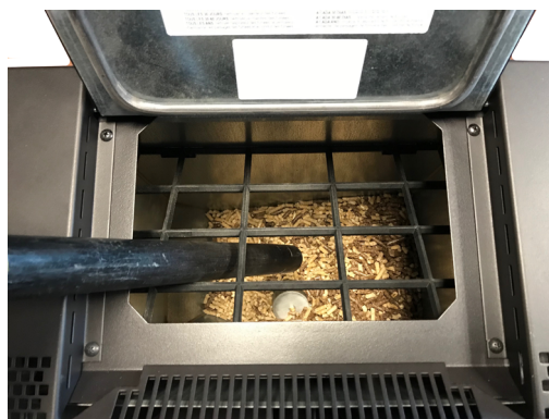
Fig. 91 - Reinigung Tank und Schnecke
