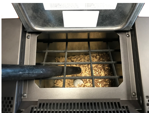
Fig. 91 - Reiniging van de voorraadbak en transportschroef
